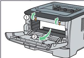
BXG014 | 5. Entfernen Sie das im Inneren des Druckers angebrachte Schutzmaterial.<br>
