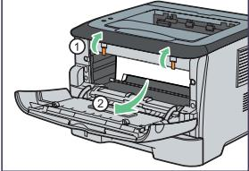
BXG014 | 5. Retirez le matériel de protection attaché à l'intérieur de l'imprimante.<br>
